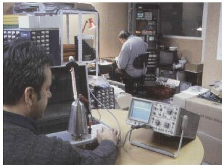
Ispitivanje u proizvodnji se sastoji od detaljne verifikacije **SKYLANCE**-a koristeći visokonaponski generator i visokonaponsku sondu, a rezultat se prikazuje na osciloskopu. Ova kontrola je najvažnija i sprovodi se na svim proizvedenim uzorcima kako bi se verifikovao kvalitet proizvoda.
